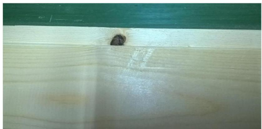
Seuls les noeuds où la lumière passe à travers et d'un diamètre de plus de 15 mm sont considérés comme un défaut.
